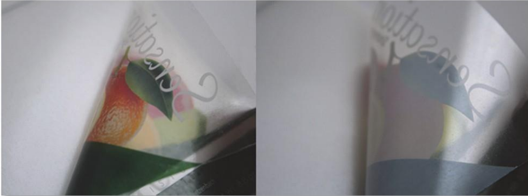
Rückseite eines klaren Etiketts mit weißem Toner bei 0% (links) im Vergleich zu einem Etikett mit weißem Toner bei 100% (rechts).
